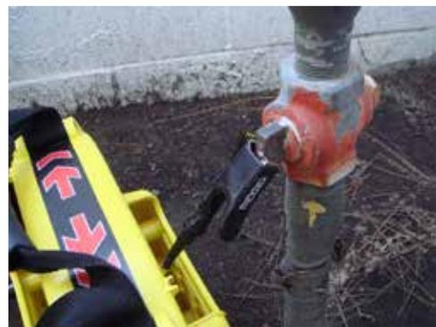
图 7 – 电缆引线夹在目标导体上
