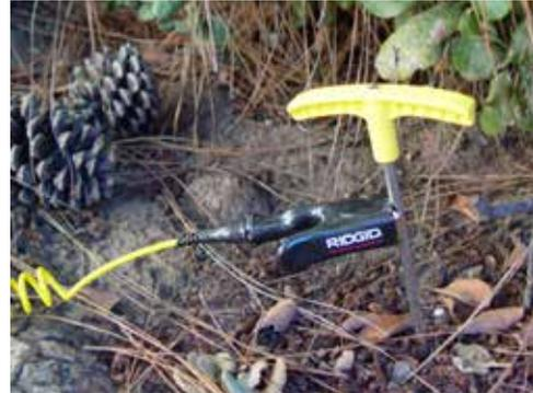
图 6 – 引线夹连接在接地棒上
