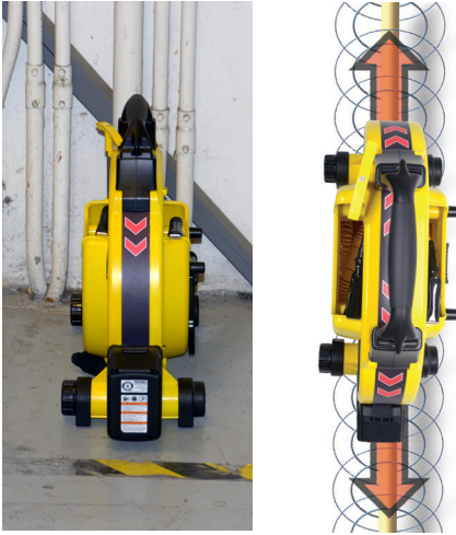
Şekil 12 – Yönlendirme okları hedef kondüktörle hizalı
