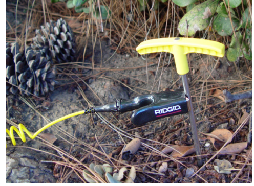
Şekil 6 – Kablo ucu klipsi topraklama çubuğuna takılı
