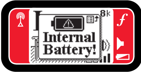
Şekil 5 – Dahili Batarya Alarmı
