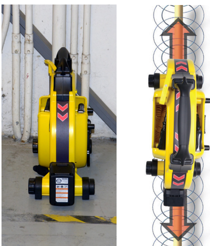
Figur 12 – Orienteringspilarna i linje med målledaren
