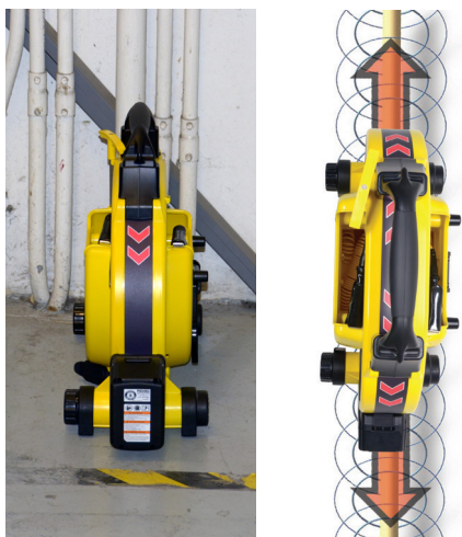
Рисунок 12 – Ориентировочные стрелки, выравненные вдоль проводника
