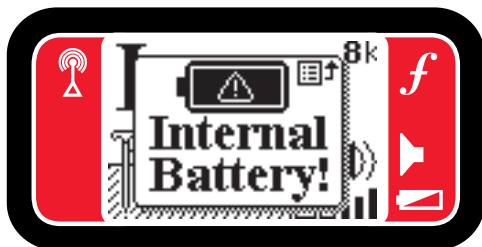
Рисунок 5 – Предупреждение о внутренней батарее
