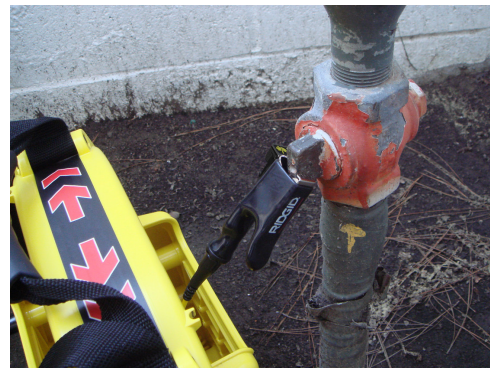
図7 - 対象導体に取り付けられたケーブルリード線
