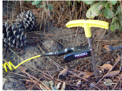
図6 - アース棒に取り付けたリードクリップ
