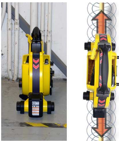
図 12 - 位置確認マークと対象導体が揃った状態
