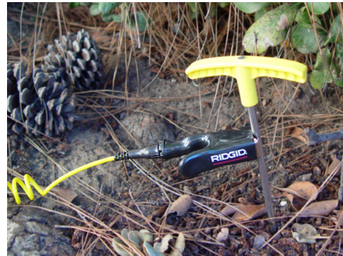
Figura 6 – Morsetto del cavo collegato al paletto di terra
