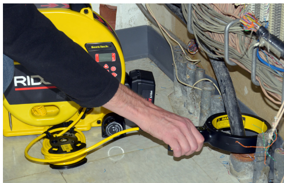
Figure 11 – Pince inductive en cours d'utilisation
