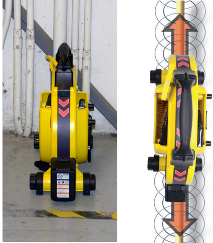
Figure 12 – Flèches d'orientation alignées avec le conducteur cible
