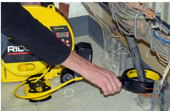
Kuva 11 – Induktiivinen puristin käytössä
