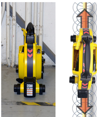
Kuva 12 – Suuntanuolet linjassa kohdejohtimen kanssa
