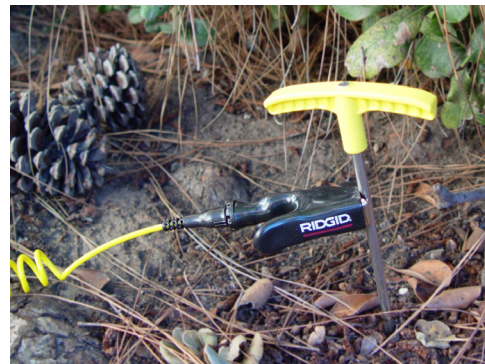
Abbildung 6 – Zuführungsklemme an einem Erdspeiß angebracht
