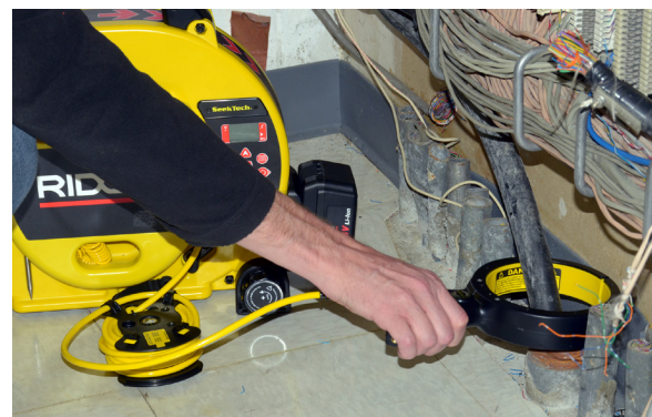
Abbildung 11 – Induktive Klammer in Benutzung
