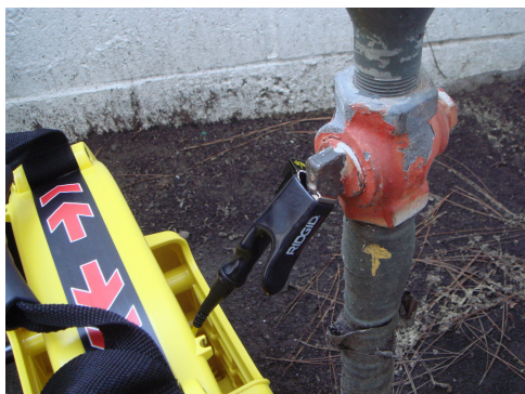
Abbildung 7 – Kabelzuführung an der Zielader angeschlossen
