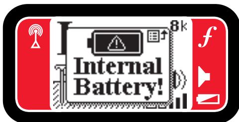
Abbildung 5 – Eingebaute Batterien Warnung
