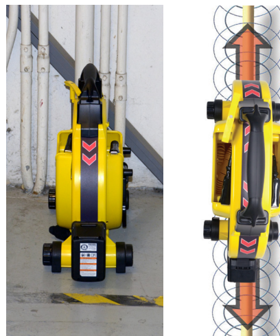
Abbildung 12 – Orientierungspfeile mit Zielader gefluchtet
