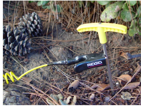
Figur 6 – Ledningsklips fastgjort til jordspyddet
