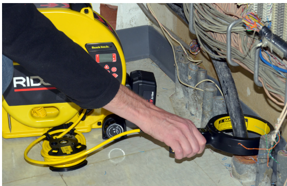
Figur 10 – Induktiv klemme i brug
