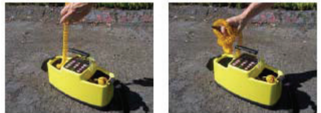
图20 — 回收连线的正确方法和错误方法示意
