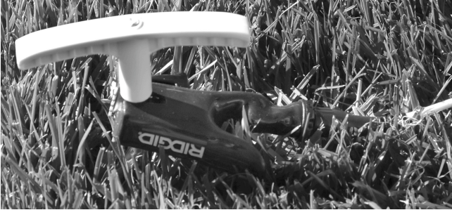
Şekil 7 - Kabloyu Topraklama Kazığına Bağlama
