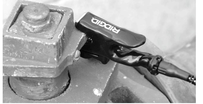
Şekil 8 - Kablo Ucunu Hedef İletkene Bağlama
