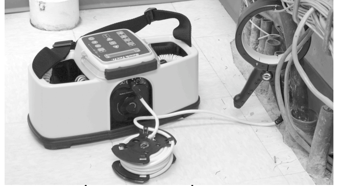
Şekil 12 - Bir İletkene Eklenmiş İndüksiyon Kelepçesi
