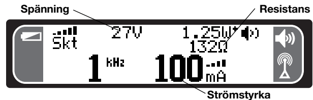
Figur 20. Displayen med värdena för resistans, spänning och strömstyrka
