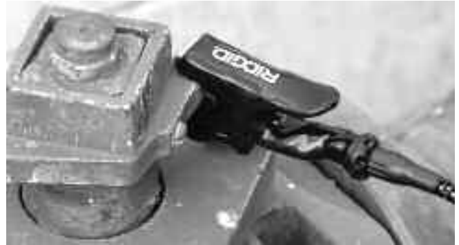
Figur 8. Ansluta kabelledningen till målledaren
