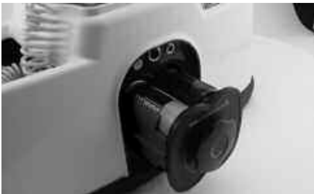
Figur 6. Ta ut batterihållaren
