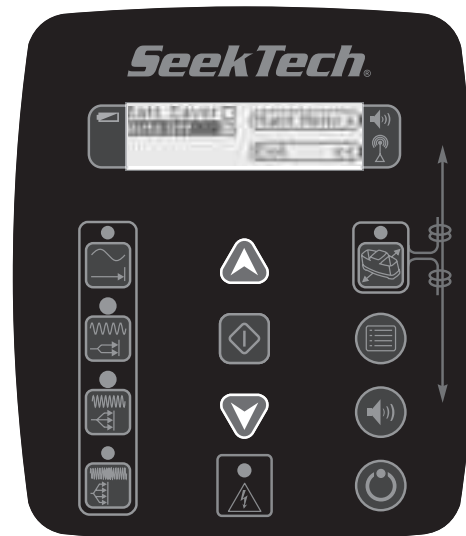
Figur 21. Välj strömstyrkealternativ med pilknapparna (upp eller ned)
