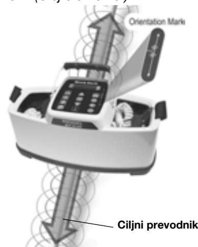
Slika 13 – Usmeritev glede na linijo v načinu Inductive Mode (indukcijski način)
