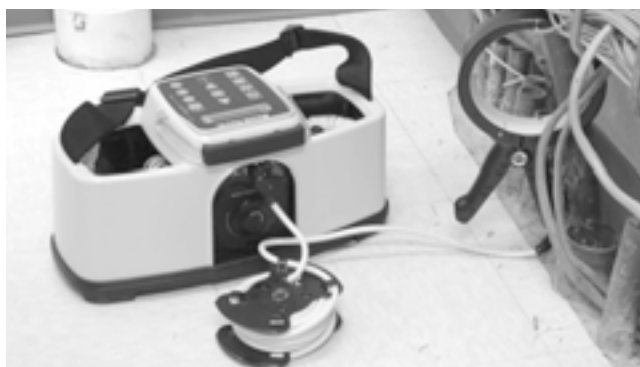
Obrázok 12 - Indukčná svorka pripojená k vodiču
