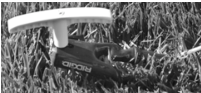
Obrázok 7 - Pripojenie vodiča k uzemňovaciemu kolíku
