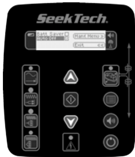
Obrázok 21 - Voľba prúdu (tlačidlá hore a dole)
