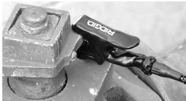
Рис. 8 – подсоединение провода кабеля к целевому проводнику
