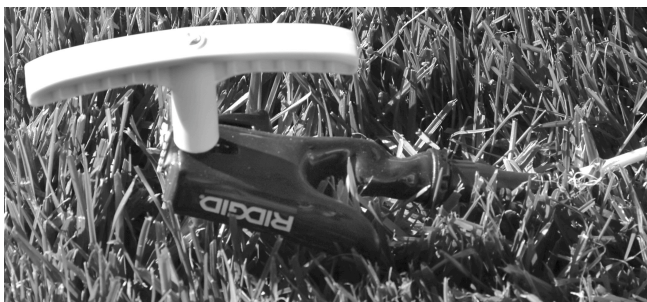
Рис. 7 – присоединение провода к заземляющему штырю
