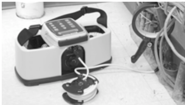
Figura 12 - Clemă inductivă atașată la un conductor
