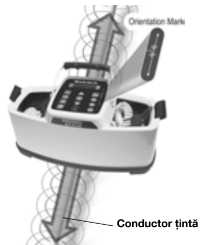
Figura 13 - Orientarea la linie - modul inductiv
