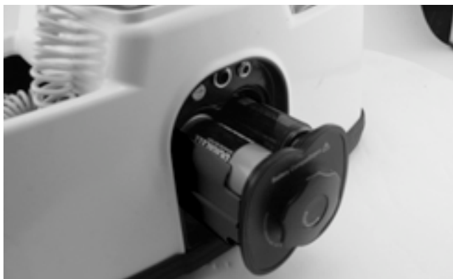
Figura 6 - Demontarea suportului acumulatorului
