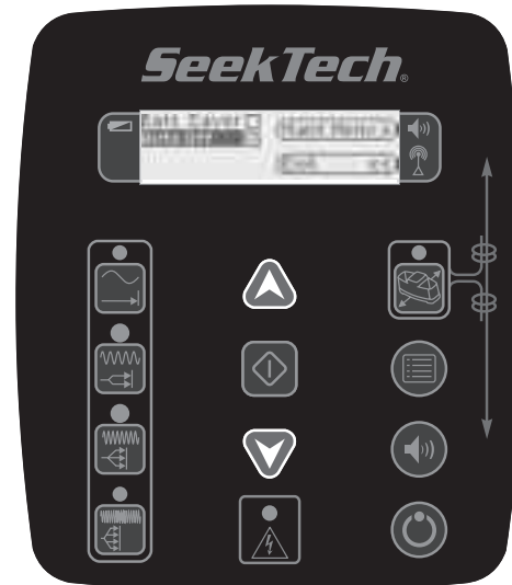
Figura 21 – Selecção da Corrente (Teclas Para Cima e Para Baixo)
