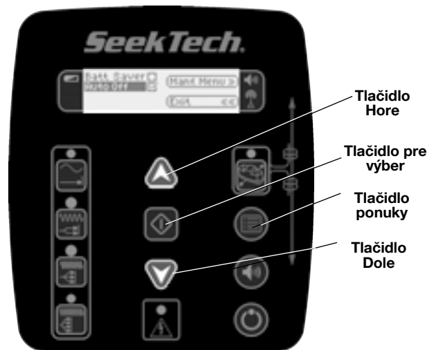
Obrázok 25 - Tlačidlá Ponuka, Hore a Dole a Vybrať
