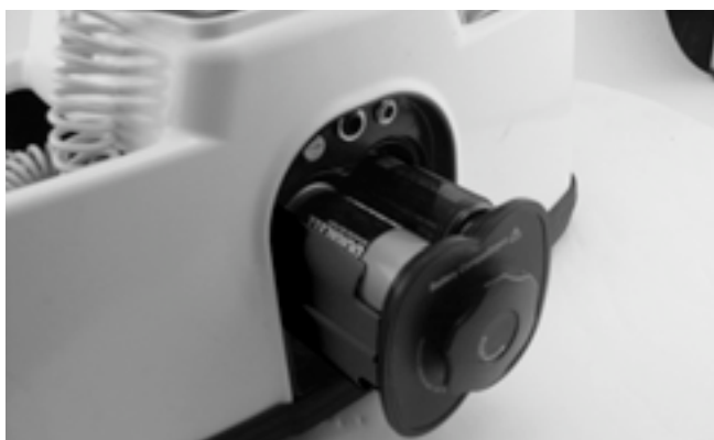
Obrázok 6 - Vysunutie držiaka batérií
