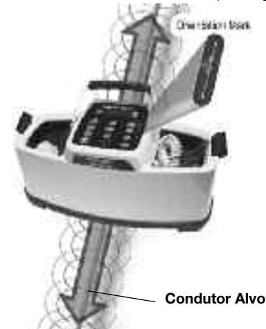
Figura 13 - Orientação com a linha - Modo Indutivo
