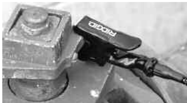
Figura 8 - Ligação do fio do cabo ao condutor alvo
