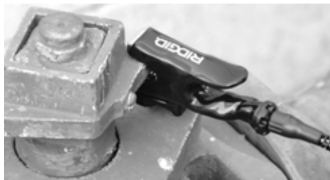
Rysunek 8 - Podłączenie przewodu kabla do przewodu śledzonego.
