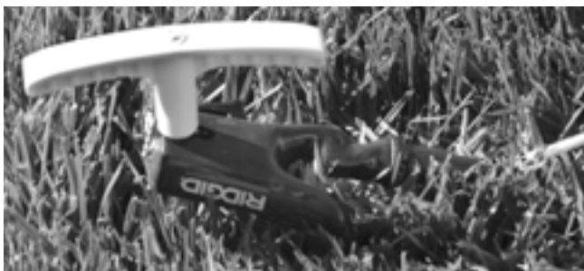
Rysunek 7 - Podłączenie przewodu od kolca uziemiającego
