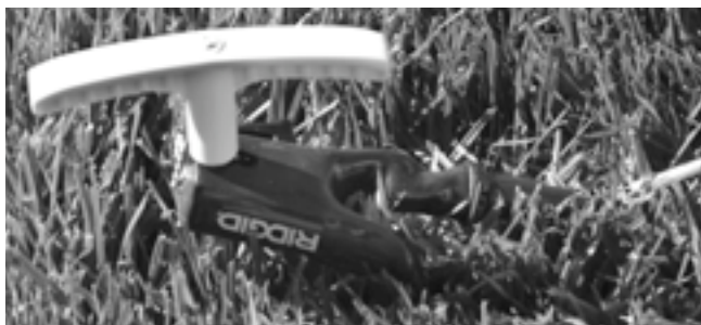
Figur 7 – Feste ledning til jordingspinne
