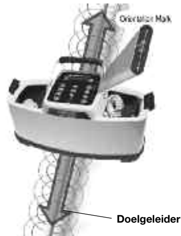
Figuur 13 – Op de leiding richten – inductieve modus
