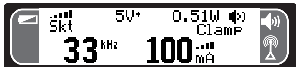
Figuur 11 – Zender in inductieve klemstand
