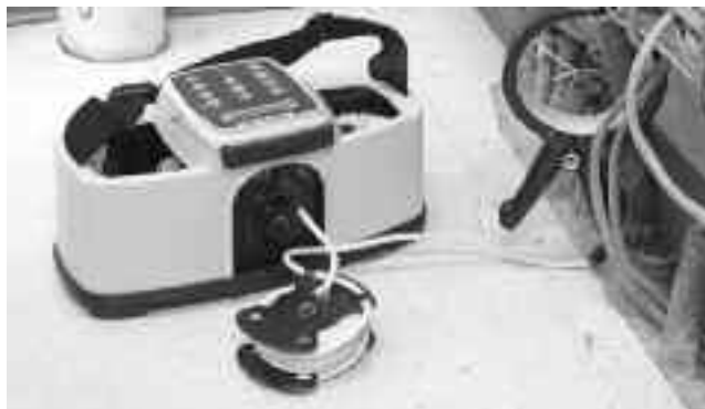
Figuur 12 – Inductieve klem op een geleider
