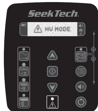
Figura 9 – Indicatore di alta tensione
