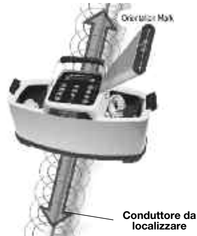
Figura 13 – Direzione rispetto alla linea – Modalità induttiva
