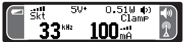
Figura 11 – Trasmittitore in modalità Pinza induttiva
