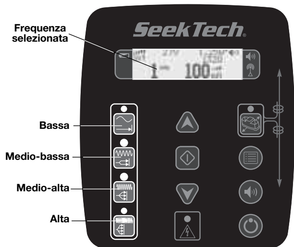
Figura 19 – Tasti di frequenza – Ricevitore/localizzatore di altro produttore
