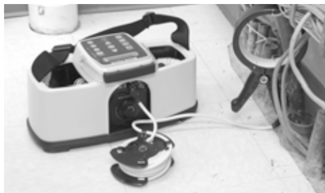
12. ábra – Induktív csipesz vezetőhöz csatlakoztatva
