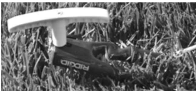
7. ábra – Vezeték csatlakoztatása a földelőpálcához
