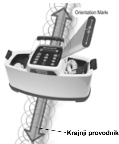
Slika 13 – Orijentacija prema vodu – Način rada indukcijom
