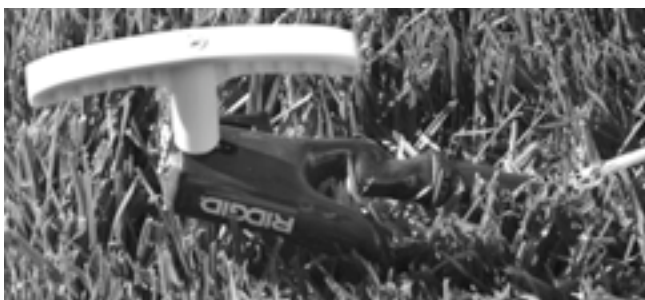
Slika 7 – Spajanje izvoda sa štapićem za uzemljenje
