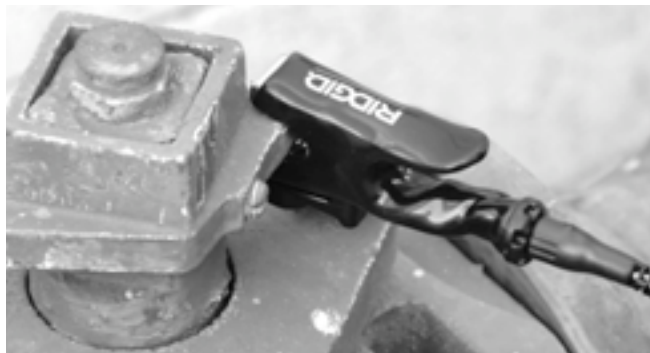
Kuva 8 – Kaapelijohdon kytkeminen kohdejohtimeen.
