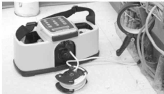
Kuva 12 - Induktiivinen puristin kiinnitettynä johtimeen
