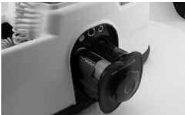
Abbildung 6 – Herausnehmen des Batteriefachs
