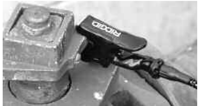
Abbildung 8 – Anschluss des Kabelkontakts an den Zielleiter
