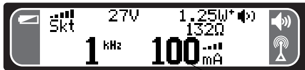
Abbildung 22 – Gewählte Stromstärke Strom
