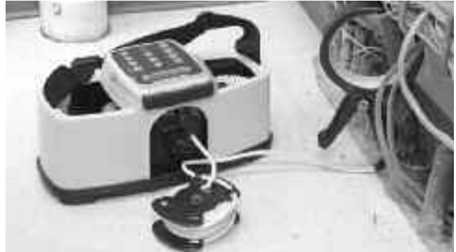
Abbildung 12 – An einen Leiter angebrachte Induktionsklammer
