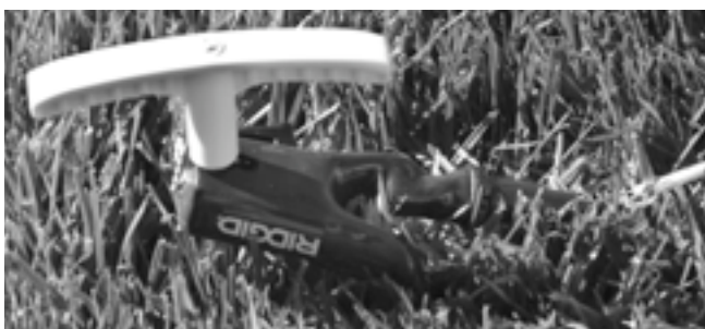
Figur 7 - Tilslutning af kabel til jordspyd
