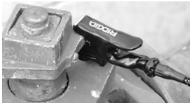
Figur 8 - Tilslutning af kablet til mållederen.
