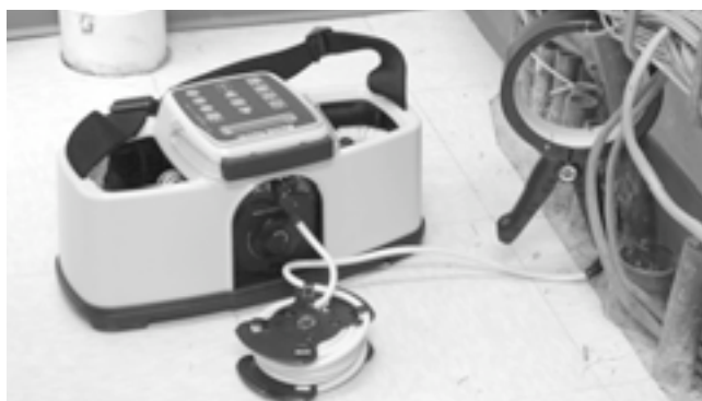
Figur 12 - Induktiv klemme tilsluttet en leder
