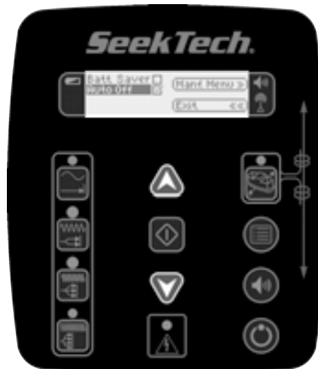
Obrázek 21 – Výběr proudu (tlačítka Nahoru a Dolů)
