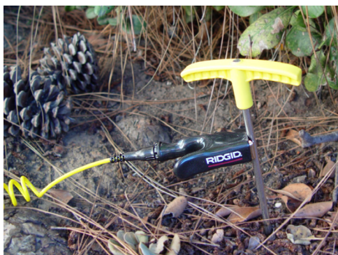
图 6 – 引线夹连接在接地棒上
