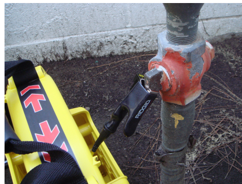
图 7 – 电缆引线夹在目标导体上
