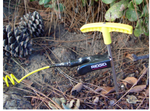
Şekil 6 – Kablo ucu klipsi topraklama çubuğuna takılı
