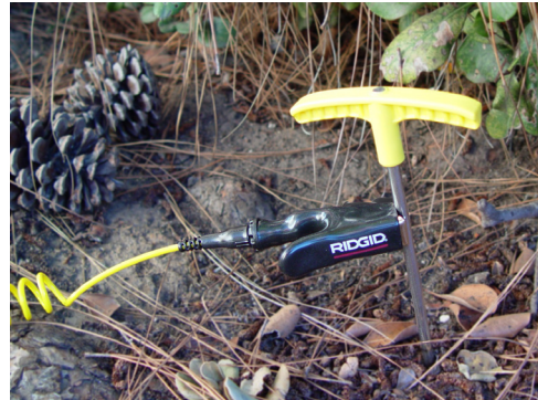
Figur 6 – Kabelledclip fastsatt på jordpinnen
