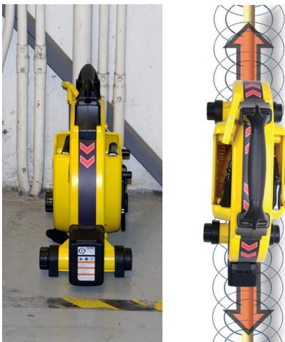
Figur 12 – Orienteringspilar i linje med målledaren
