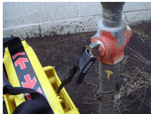
Figur 7 – Kabelledclip till målledare
