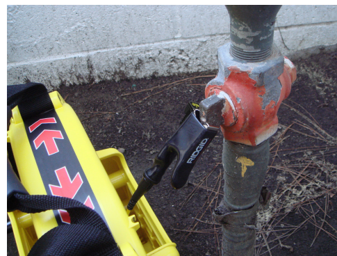
Figur 7 – Kabledledningsklemme koblet til målleder
