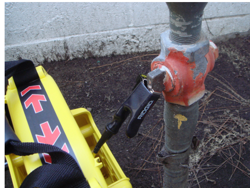
Afbeelding 7 – Kabelverbinding op doelgeleider geklemd
