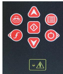
図4 - 高電圧LEDインジケータ
