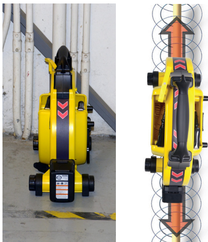
Figura 12 – Frecce di orientamento allineate con conduttore bersaglio
