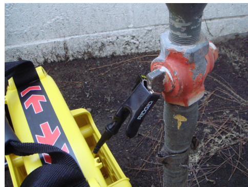
Figura 7 – Morsetto del Cavo pinzato al conduttore bersaglio
