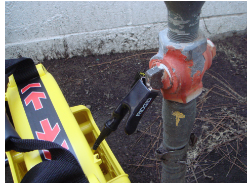
Kuva 7 – Kaapelijohto puristettu kohdejohtimeen
