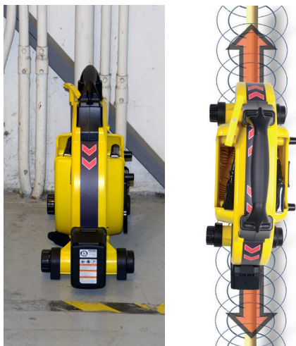
Abbildung 12 – Orientierungspfeile mit Zielader gefluchtet
