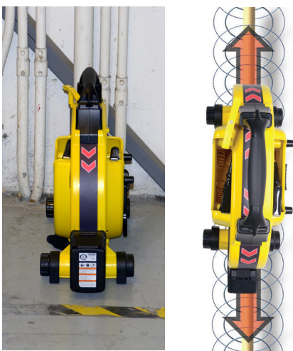
Figur 11 – Orienteringspile på linje med målleder
