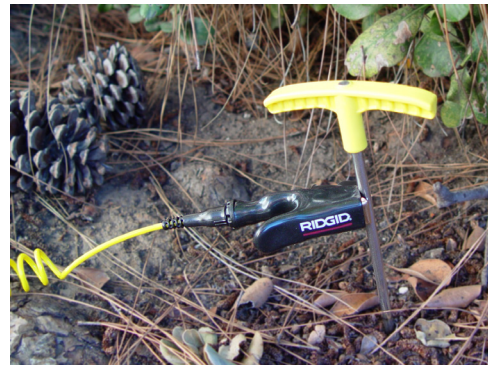
Figur 6 – Ledningsklips fastgjort til jordspyddet
