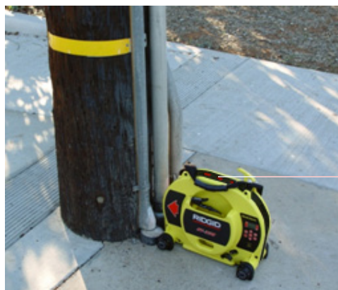
図16 - 位置確認マークと対象導体が揃った状態
