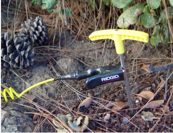
**Figura 10 – Conectando el conductor del ST-33Q a la vara de tierra.**
