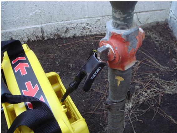
**Figura 11 – Conectando el conductor del cable del ST-33Q al conductor objetivo**
