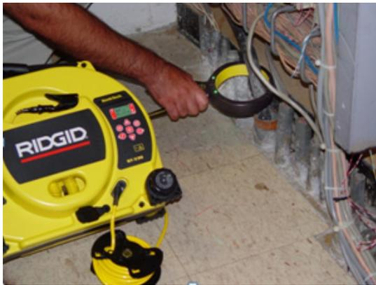
Figura 15 – Abrazadera inductiva conectada a un cable
