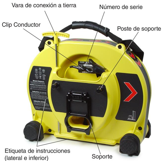
**Figura 2 – Componentes de la vista posterior del transmisor**
