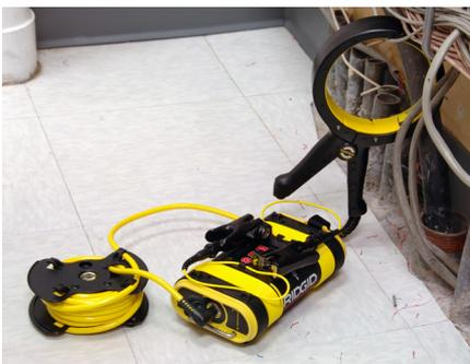
4. Appuyer sur la touche Mise sous tension
