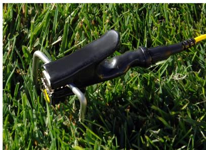
Plutôt que d'utiliser le piquet de mise à la terre fourni, la pince de câble peut être attachée à d'autres objets tels qu'une lame de pelle ou une tige de métal enfoncée dans le sol. L'utilisation d'un objet de plus grande taille pour la mise à la terre peut améliorer celle-ci en accroissant la surface de contact avec le sol.
