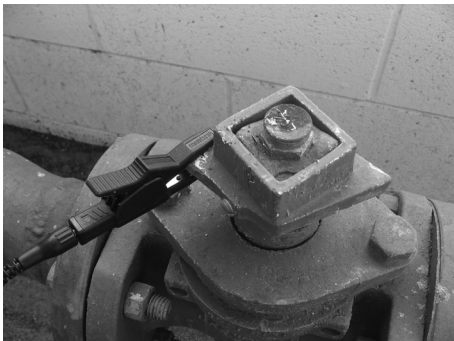
Рис. 7: Соединение прибора ST-305 с магистралью
