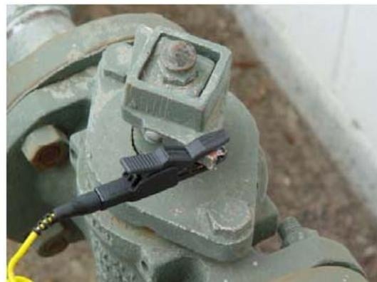
Figura 5: Conexão do ST-305 a uma linha
