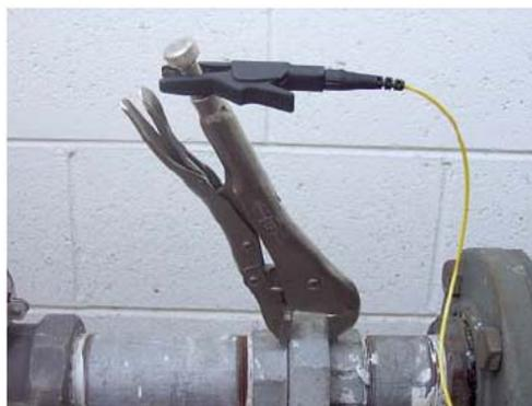
Figura 6: Método de conexão alternativo
