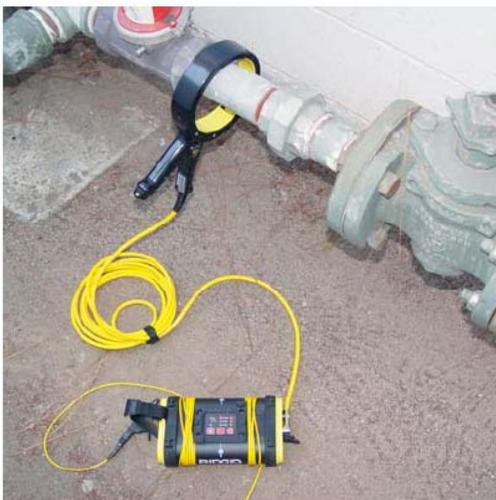
**Figura 10: Grampo indutor conectado a um condutor**
