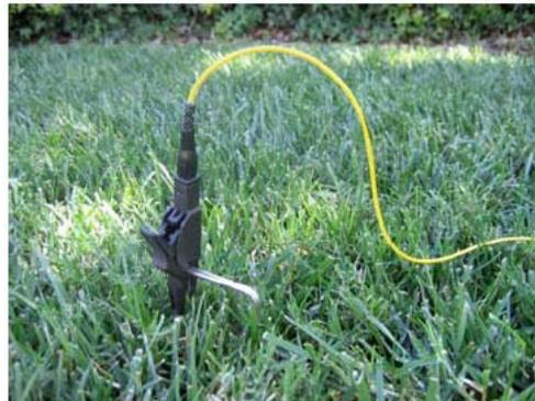
Figura 4: Conexão da vareta de conexão terra ST-305
