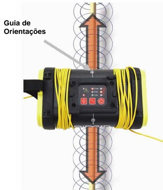
**Figura 11: Orientação para o modo de indução – da linha**
