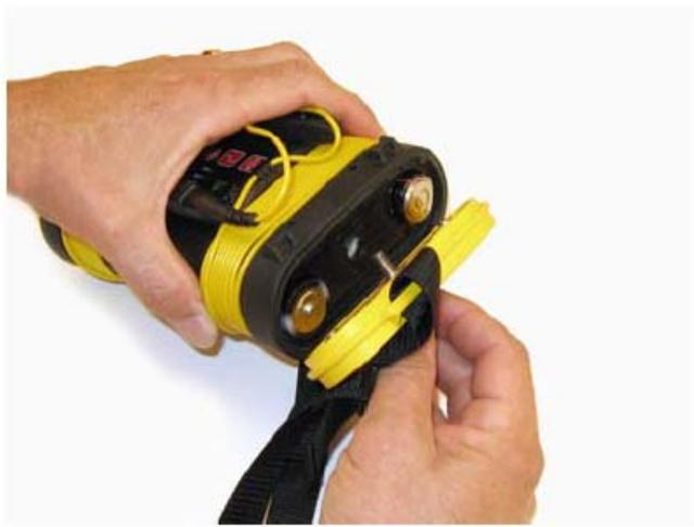
**Figura 3: Remoção da tampa da bateria**
