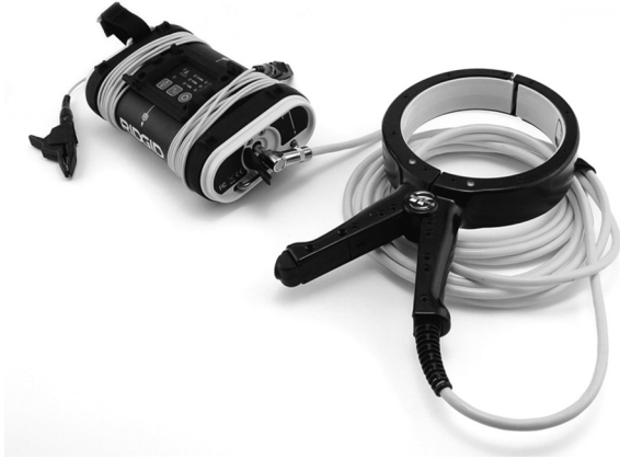
Rysunek 8: Nadajnik ST-305 z opaską indukcyjną
