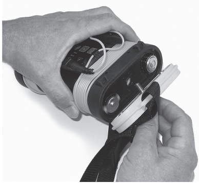
Figur 3: Ta av batteridekselet
