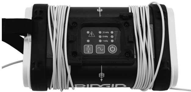
Figur 11: ST-305 i induktiv modus ved 33 kHz
