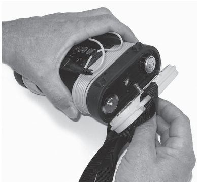
Figuur 3: verwijderen van het batterijdeksel
