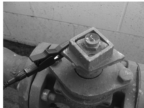
Figuur 7: De ST-305 aansluiten op een leiding
