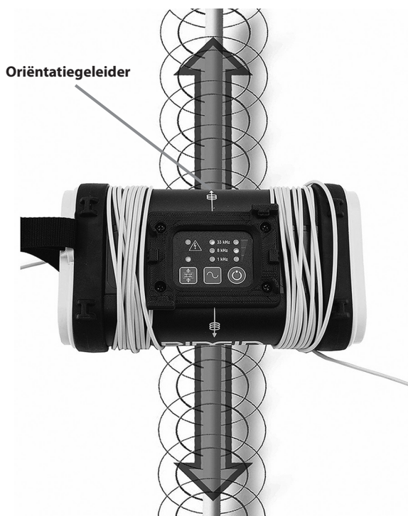
Figuur 10: oriëntatie ten opzichte van de leiding – inductieve modus
