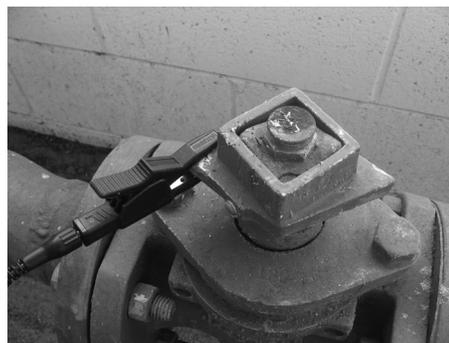
Figura 7: Collegamento dell'ST-305 a una linea
