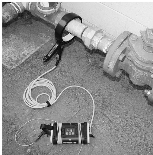
Figura 9: Morsetto induttivo collegato a un conduttore
