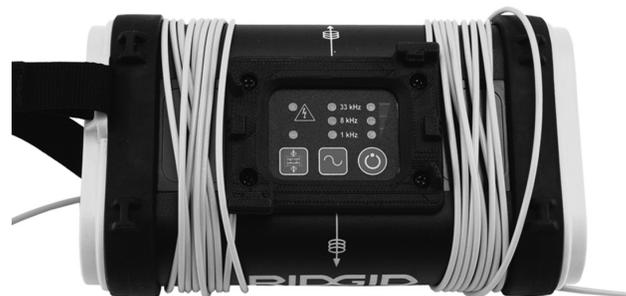
Figura 11: ST-305 in modalità induttiva a 33 kHz
