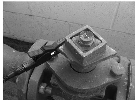
Abbildung 7: Anschließen des ST-305 an eine Leitung
