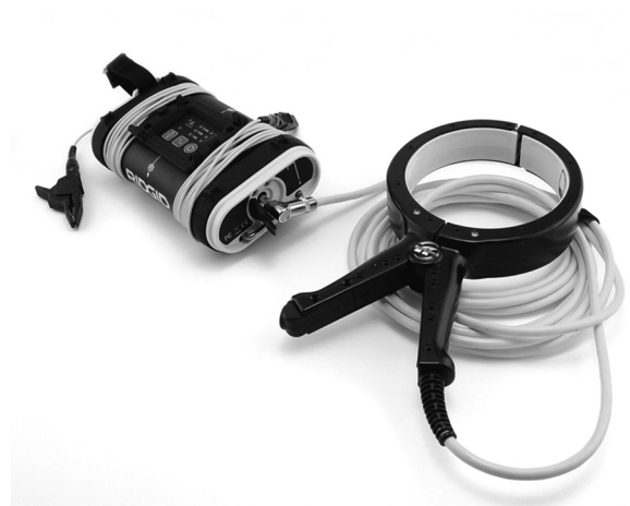
Abbildung 8: ST-305 mit Induktionsklammer
