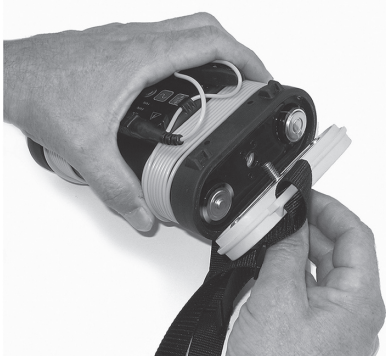
Abbildung 3: Entfernen des Batteriedeckels
