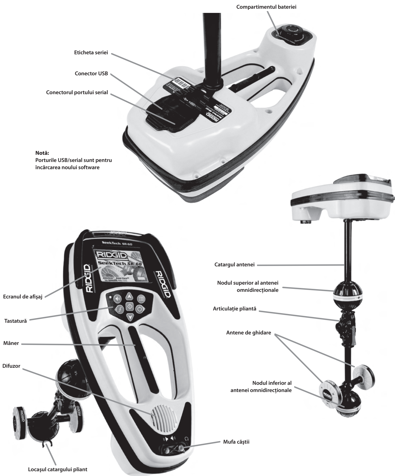
Figura 1: Componentele SR-60
